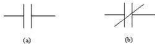
**Figura N° 12 a y 12 b. Contacto NA y Contacto NC Fuente: Sosa, S. (2017)**
