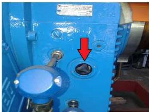
Figura 8. Visor de nivel de aceite en cojinetes.
