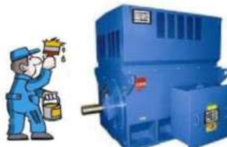
Figura 6. Dibujo para la aplicación de antioxidante a ejes y superficies del motor.
