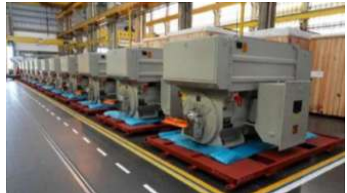
Figura 4. Almacenamiento de motores eléctricos en interior.
