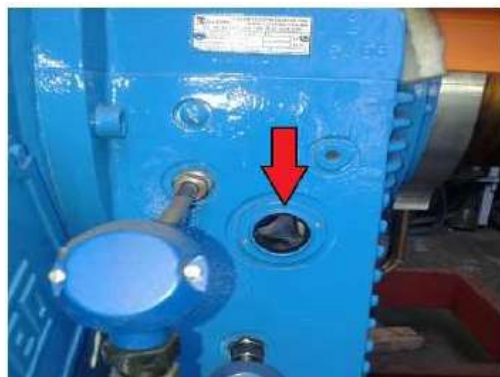
Figura 8. Visor de nivel de aceite en cojinetes.
