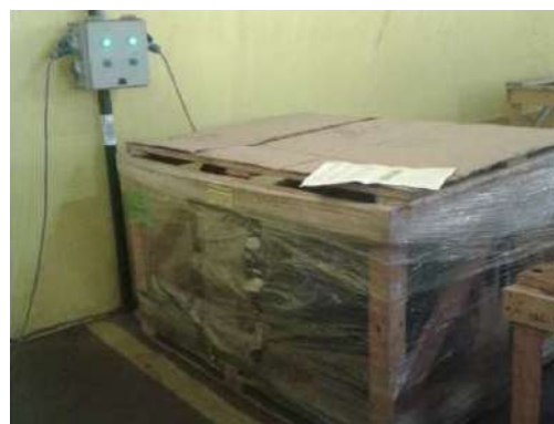
Figura 9. Embalaje ideal para protección contra vibración natural.
